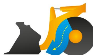
Presión máxima en el pedal de avance lento/freno: la cargadora de ruedas se detiene, Fuerza máxima para el sistema hidráulico.
