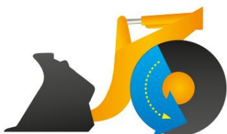
Ausencia de presión en el pedal de avance lento/freno: Máxima potencia de tracción.
