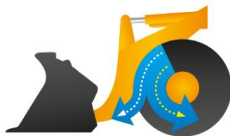
presión normal en el pedal de avance lento/freno: Reducción de velocidad, más potencia en el sistema hidráulico de servicio.
