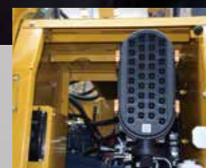
Limpiador de aire
