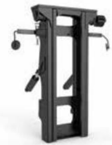
Equipamiento estándar: Mástil dúplex para una excelente visibilidad.
