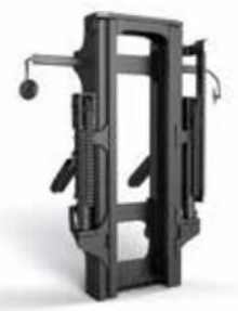
Mástil dúplex con elevación libre. Los cilindros de elevación están ubicados en el costado del mástil y permiten una vista sin restricciones a través del centro abierto del mástil.
