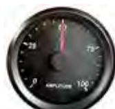
Cuando la excéntrica regulable (2) gira a la posición que se muestra en la figura anterior, la amplitud es del 50%.
