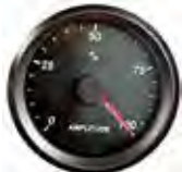
Cuando la excéntrica regulable (2) gira a la posición que se muestra en la figura anterior, la amplitud es del 100%.
