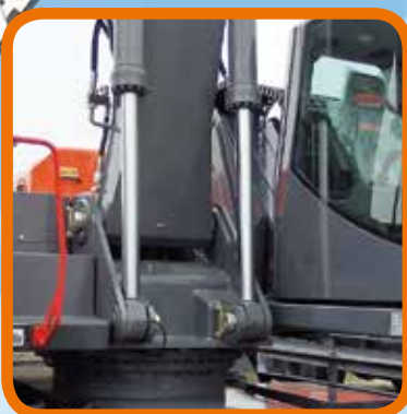
Circuito hidráulico optimizado
