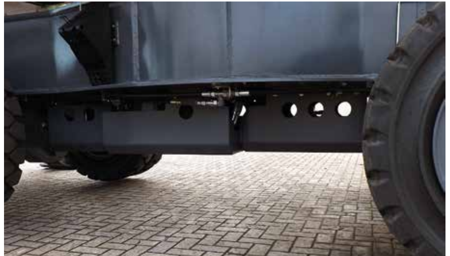
PROTECCIÓN DE TRANSMISIÓN
