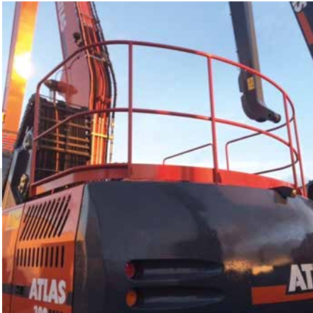
PASAMANOS DE SUPERESTRUCTURA
