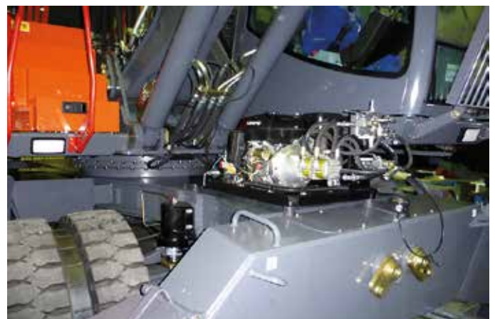
UNIDAD DE EMERGENCIA DE GASOLINA PARA MOVER LA MÁQUINA
