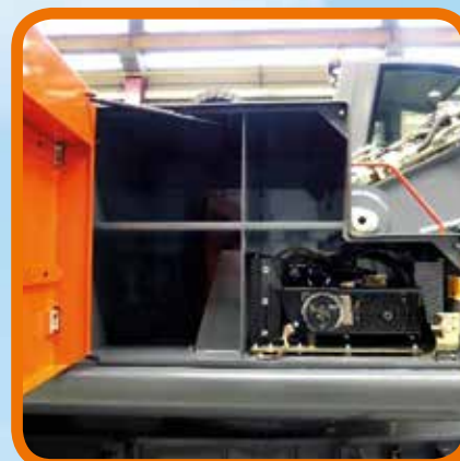
Compresor para calefacción eléctrica y sistema de climatización
